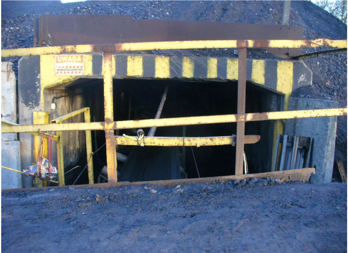
Fot. 38. Wylot lunety z taśmą T-116a z pod stożka materiału podsadzkowego
